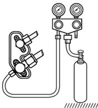
Заполните систему азотом до давления 4,15МПа. Во избежание попадания в систему жидкого азота, расположите баллон клапаном вверх.
